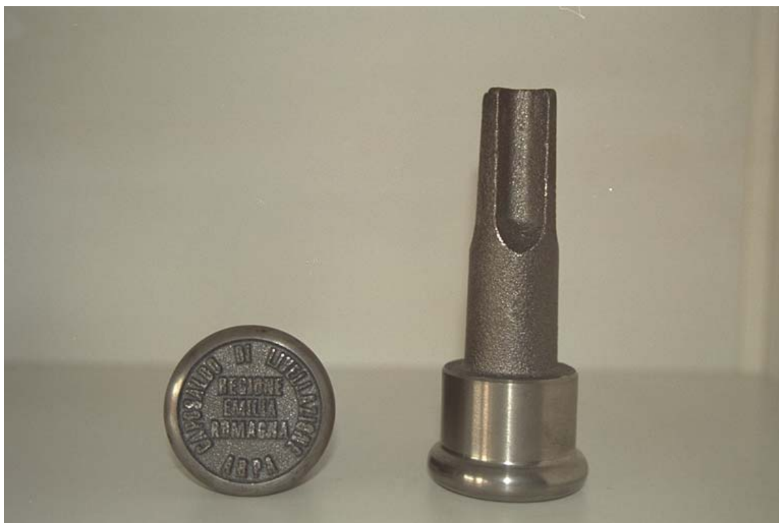
Fig. 2 Caposaldo di livellazione a pomello o toroidale
