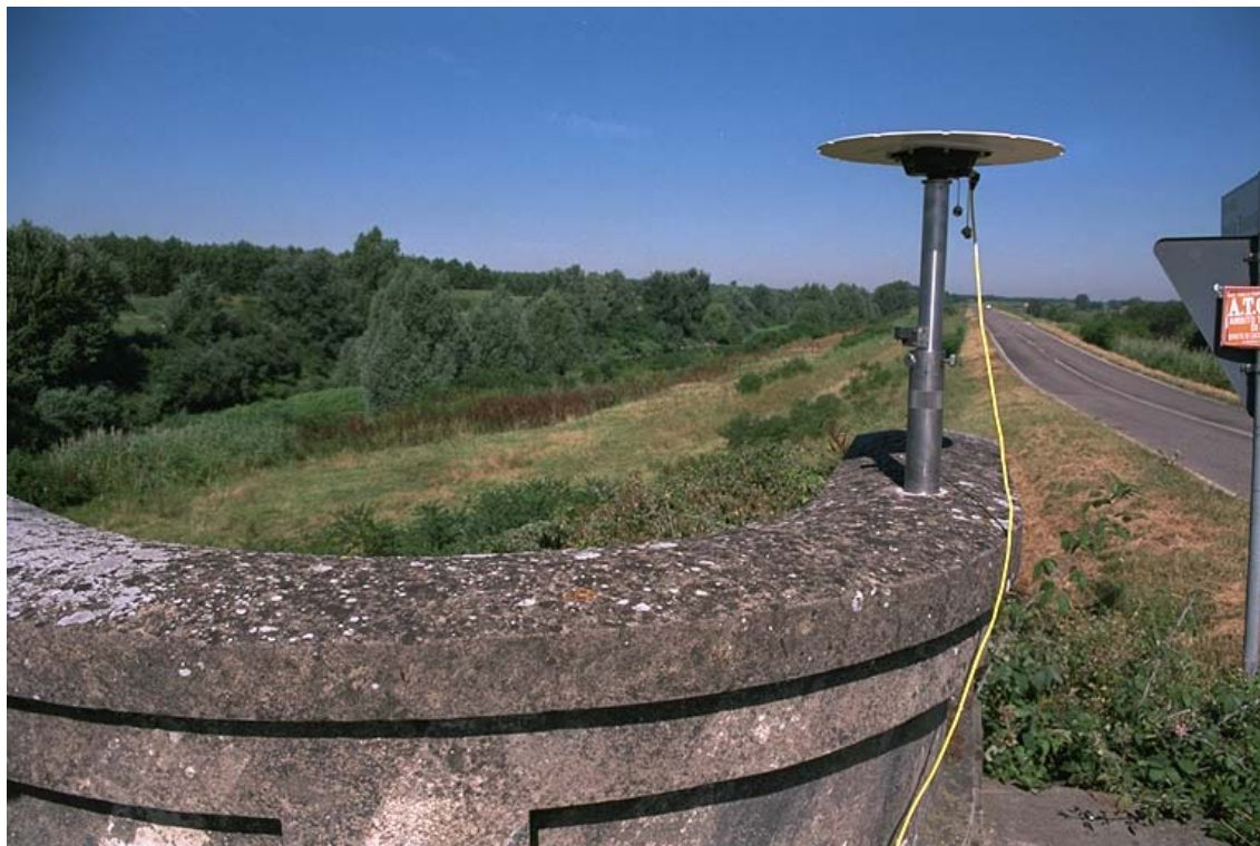
Fig. 3 Caposaldo GPS del tipo 3D UNIBO
